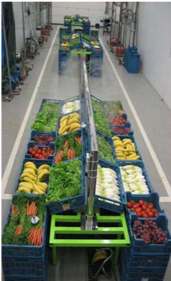
Foto 1. Configuración de la prueba de los tres expositores de productos frescos. De delante a atrás, expositor Contronics, con refrigeración y normal.
